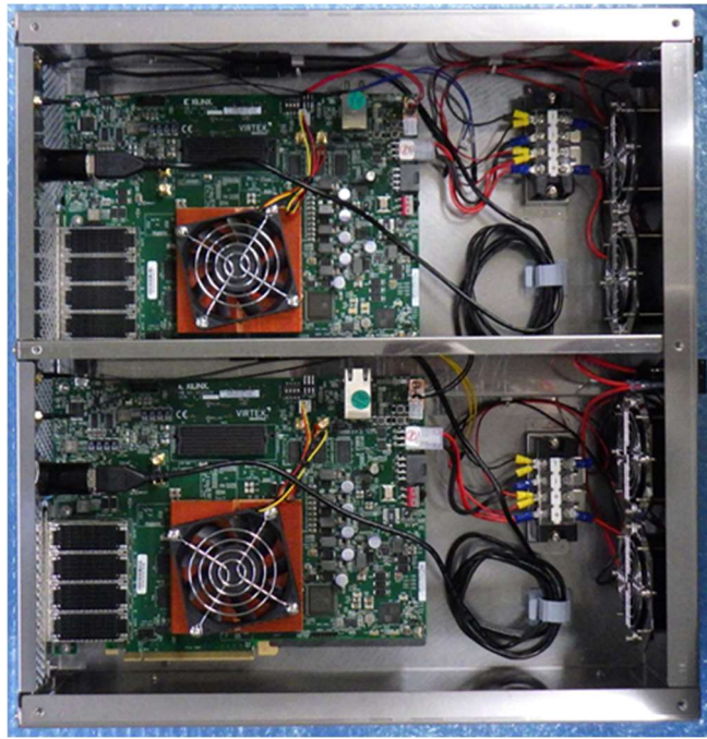
図 1.2.5-32 光 ToR スイッチ#2 (リンク維持送受信器) の試作
